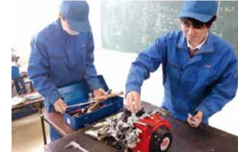
機械の分解・組立を行い、機械の構造や仕組み、工具の使い方を学びます。
